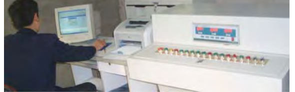
▲ 8000m 3 /h泵全性能测试台
